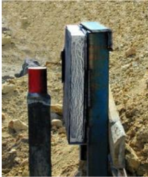
شکل (۲۲): قراردان ساندویچ پنل فوم فلزی در کنار مواد منفجره
