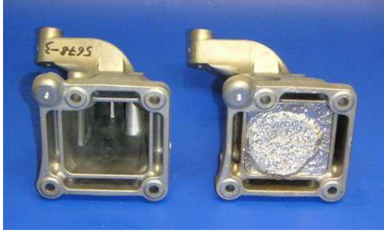
شکل (۳): سگ دست موتور اتومبیل که با فوم فلزی پر شده است
