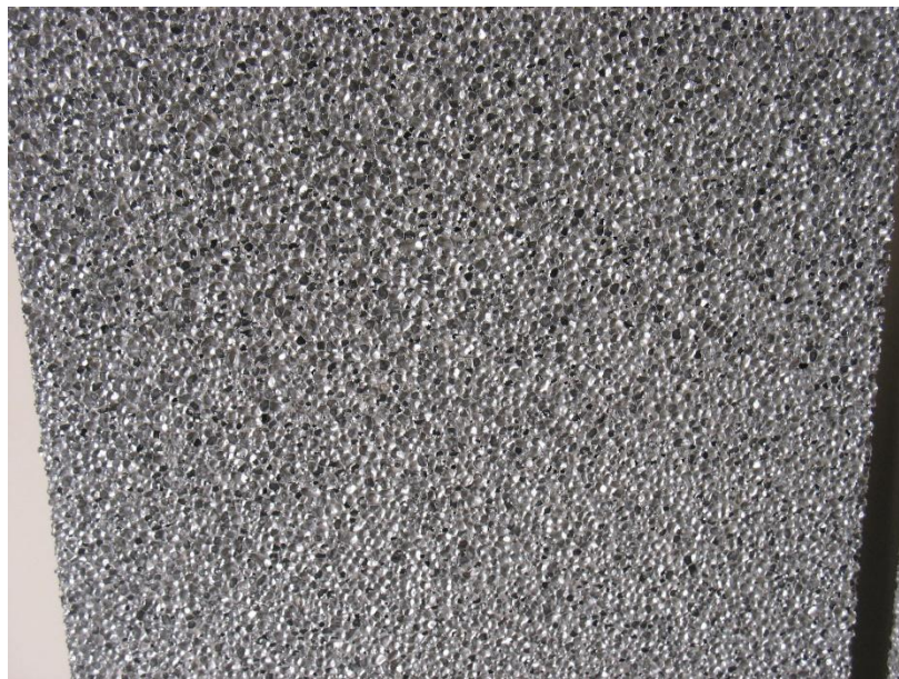
شکل (۲۷): نمونه فوم آلومینیومی ساخته شده در شرکت نوین رهیافت
