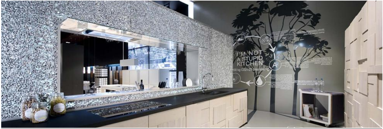
شکل (۲۵): استفاده از فوم آلومینیومی در ساخت دیوار آشپزخانه در آپارتمان ها
