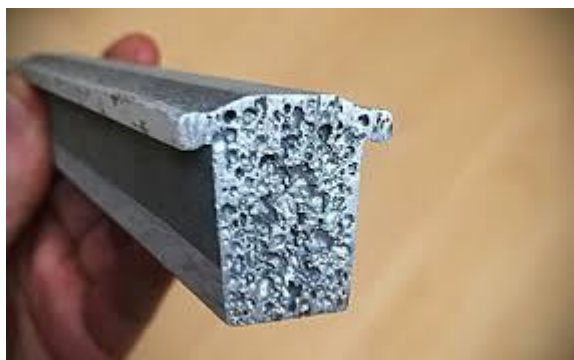
شکل (۸): استفاده از ساندویچ پنل فوم آلومینیومی برای ساخت بخش‌های مختلف سازه‌های دریایی
