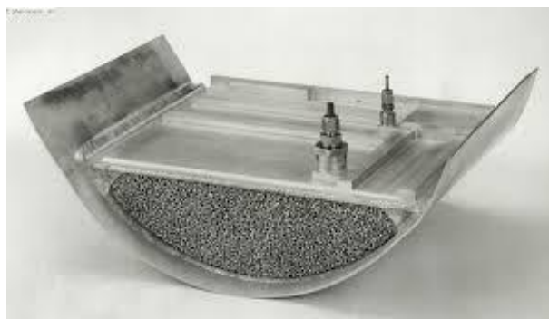
شکل (۸): استفاده از ساندویچ پنل فوم آلومینیومی برای ساخت بخش‌های مختلف سازه‌های دریایی
